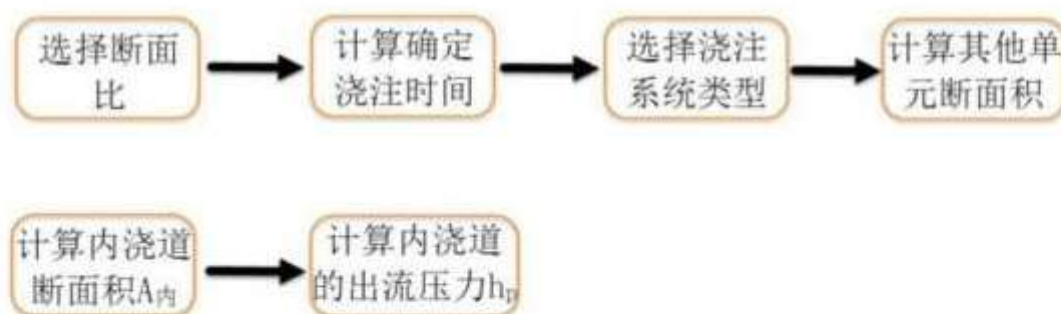
图 4.1 断面比设计法的设计步骤
